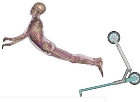
**Abb. 3** Der Moment kurz nach dem Aufprall in der Simulation. Das Menschmodell wird über den Lenker in die Luft katapultiert.
